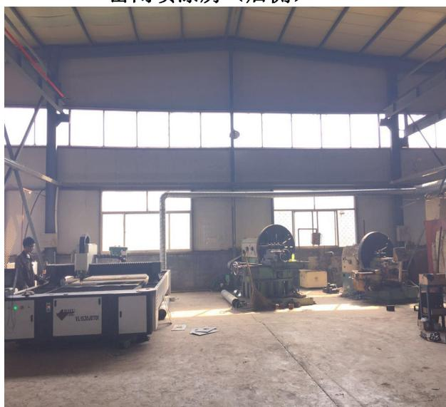
切割机废气收集管道（机加工车间）
