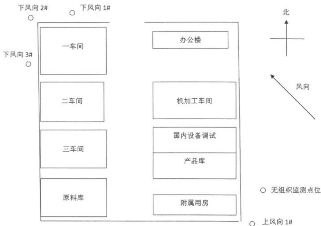
图 5-1 无组织废气检测点位
